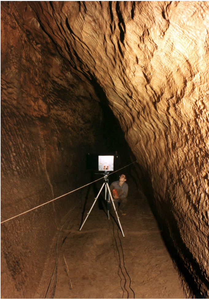
6. Kép: Vass Imre-barlang, Háromszög folyosó. Metszetkép készítése profilográf-fal.
