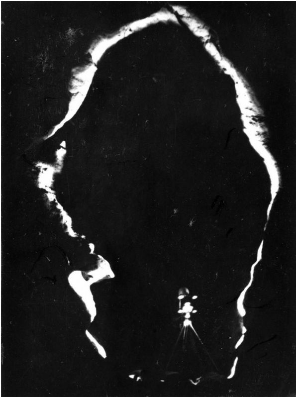
1. Ábra: Mátyás-hegyi-barlang, Óriások útja. Profilográfával készült metszet kép és annak átrajzolása. A műszeren lévő négy pont 25cm-re van egymástól.
