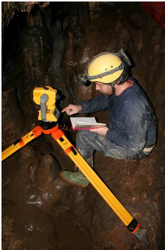
3.6. kép: Teodolitos mérés a Baradlában
