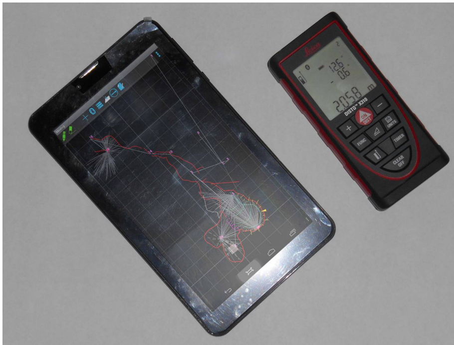
3.4. Ábra: DistoX2 és Androidos tablet TopoDroid programmal
