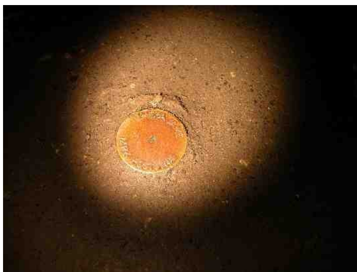
3.11. kép: Talppont a szlovéniai Predjama barlangban. Ilyen egységes pontokat alkalmaznak a környék több idegenforgalmi barlangjában, pl. a Škocjan árvizes részein is.
