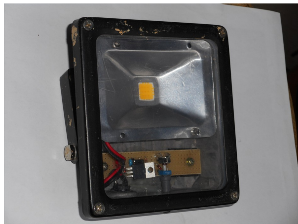
10W-os reflektor beépített szabályozással
