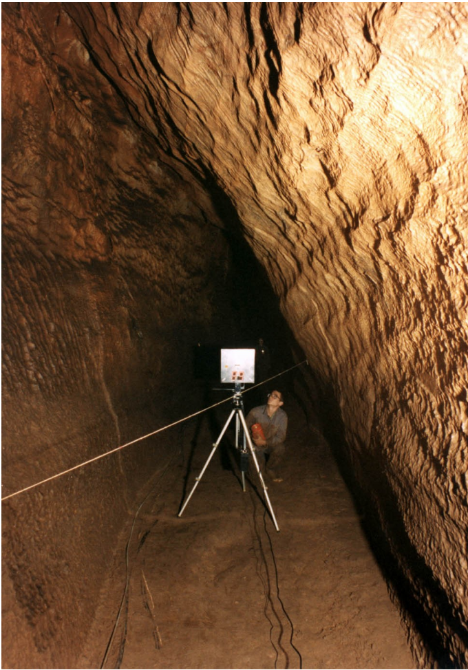
6. Kép: Vass Imre-barlang, Háromszög folyosó. Metszetkép készítése profilográfval.
