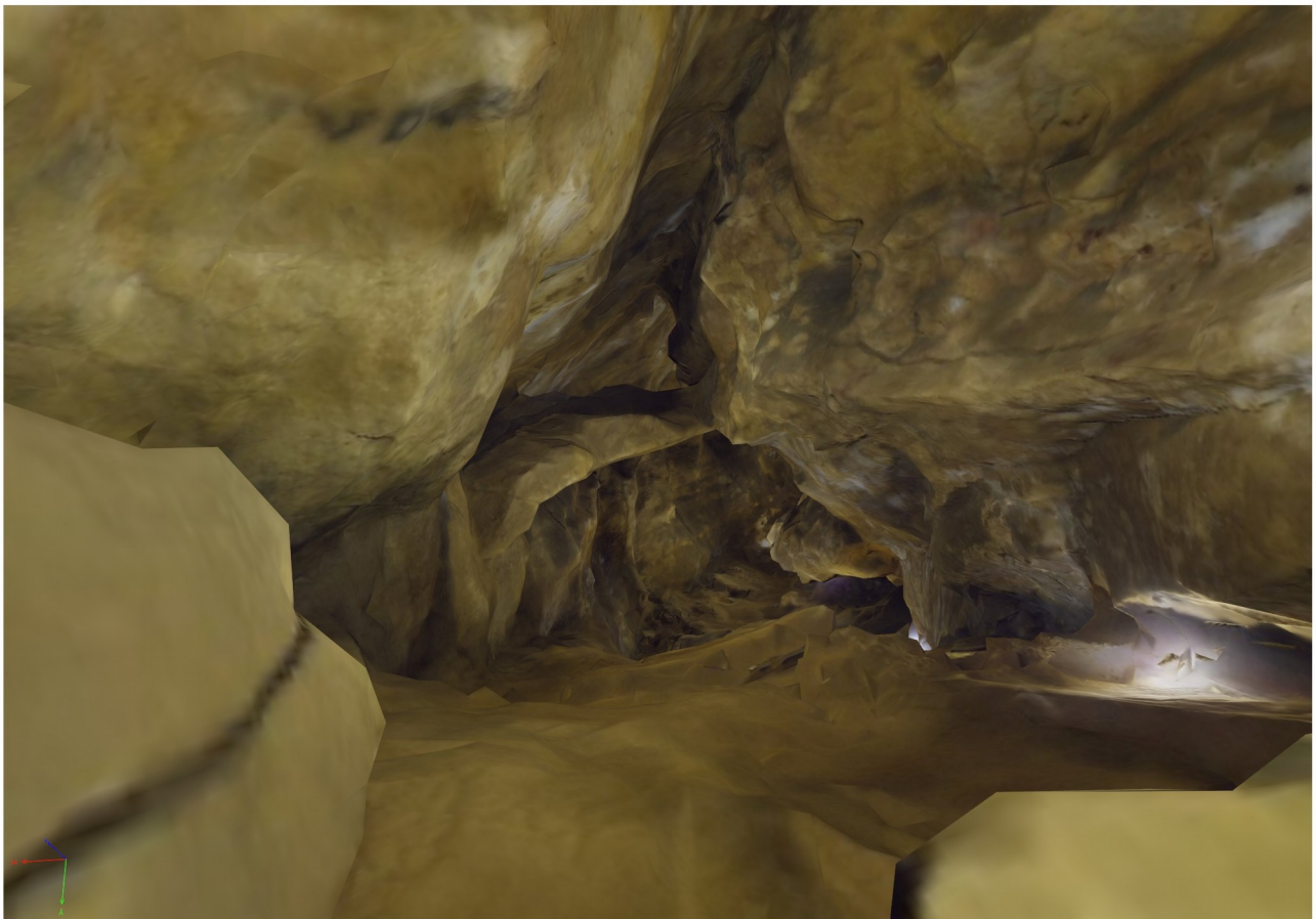
7. Ábra: Mátyás-hegyi-barlang, Sóhajok-hídja. Textúrázott felületmodell fotómodellezéssel.
